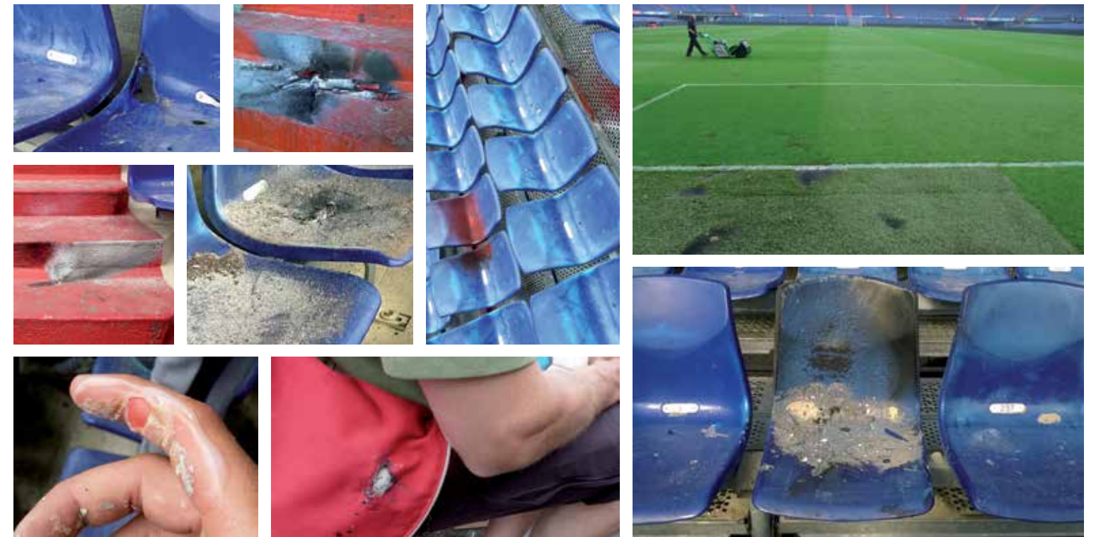
Praktijkvoorbeelden van brandschade bij supporters en in De Kuip die is ontstaan door het afsteken van vuurwerk.
